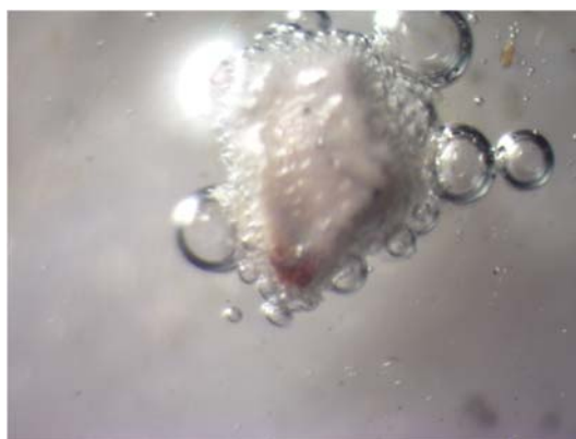
Рис. 3. Проба грунта после реакции с азотной кислотой ( \text{HNO}_3 ). Выделение углекислого газа ( \text{CO}_2 )
